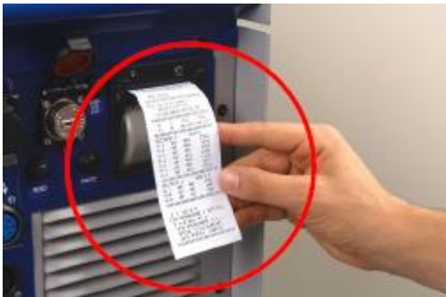
Wbudowana drukarka ułatwia monitoring parametrów
