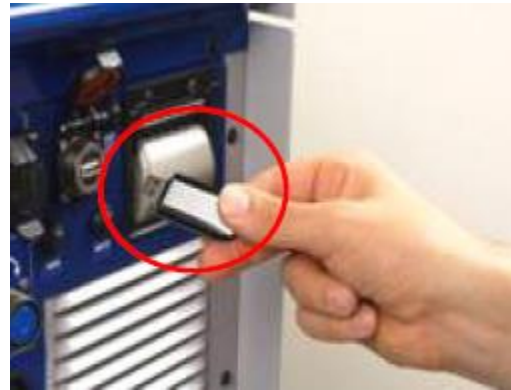
Złącze USB do wgrywania ładowania parametrów procesu spawania (archiwizacja)
